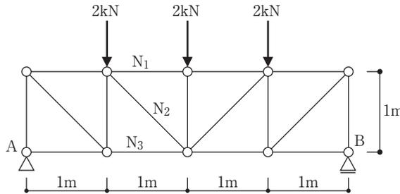
切断法により、軸方向力 $N_1$ 、 $N_2$ 、 $N_3$ を求める。
