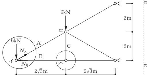
② 部材A、B：図式解法による
