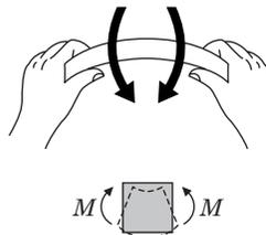
軸方向力は綱引き、せん断力は紙をハサミで切る、曲げモーメントは棒を曲げて折る、そんなイメージ。
