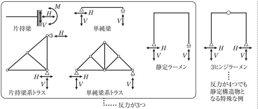
(2) **不静定構造物**：静定構造物より丈夫な構造物（反力数4以上）。
