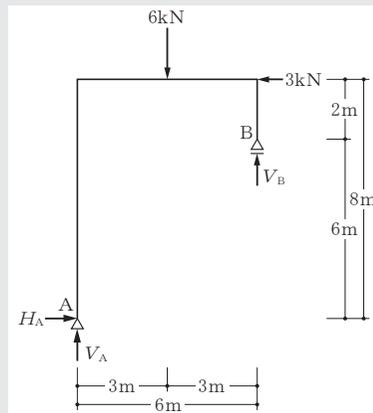
反力が2つある回転支点Aを回転の中心にして  $\Sigma M_A = 0$  のつり合い式を計算すると、移動支点Bの鉛直反力  $V_B$  が簡単に求められる。
