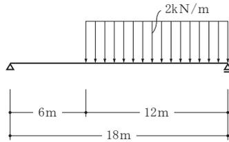
例題2④より、せん断力が0の位置で曲げモーメントが最大となる。したがって、せん断力が0になる位置を求めて、その位置における曲げモーメントを算定する。
