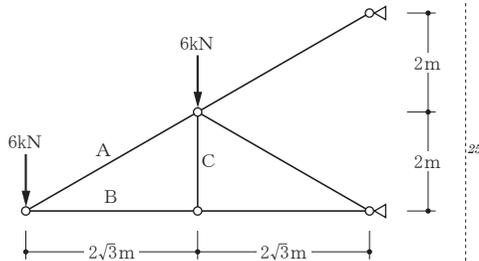
節点法により、軸方向力  $N_A$ 、 $N_B$ 、 $N_C$  を求める。
