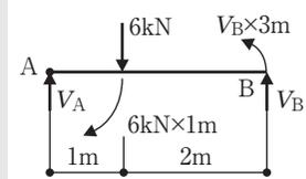
このように、まず最初に、求める反力の反対側の支点で $\Sigma M = 0$ のつり合い式を計算すると、効率よく反力が求められる。
