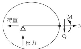
反力も応力も、3つの力のつり合い条件式 ( $\Sigma X = 0$ 、 $\Sigma Y = 0$ 、 $\Sigma M = 0$ ) を使って求めることができる。
