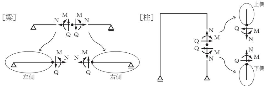
上記のように、切断してどちらを取り出すかによって応力の仮定の向きが反対になる。
