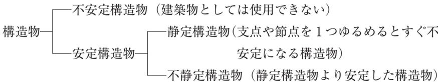
1 不安定構造物と安定構造物（静定構造物・不静定構造物）
