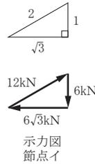
$$N_A = +12\text{ kN} \text{ (節点イを引張っている引張力なので+)}$$
